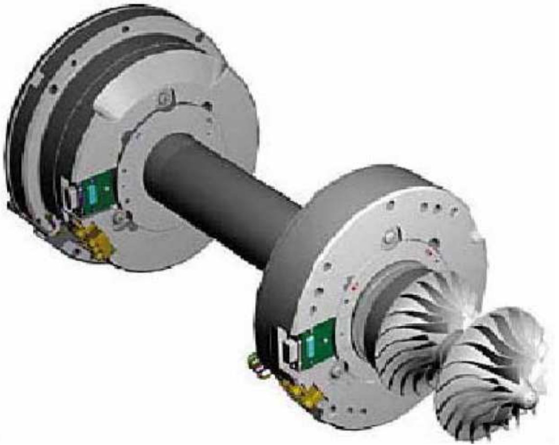
Figura 6: perspectiva general del conjunto rotor-rodetes-cojinetes
