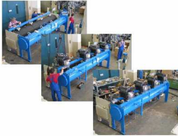
Figura 18: Los compresores se montan sobre las unidades
