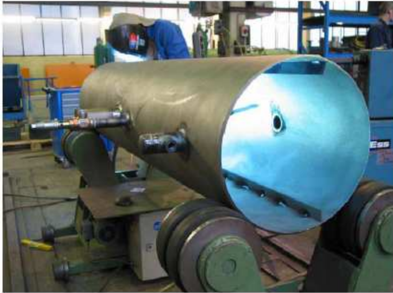
Figura 16: Fabricación de la virola de un intercambiador de unidad QUANTUM
