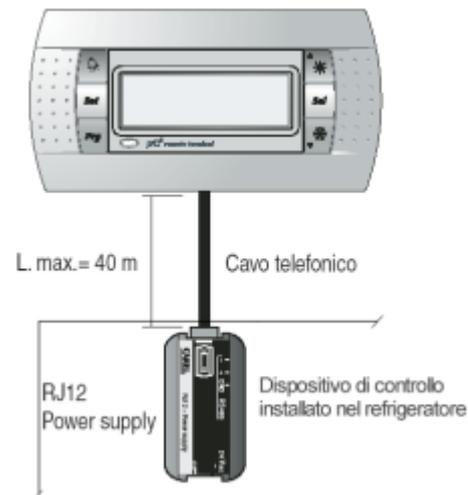
La conexión entre el terminal remoto y la máquina se realiza por medio de un cable telefónico que puede tener un largo máximo de **40 metros**.
